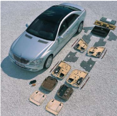
Onderdelen met hennepvezels uit de Mercedes-S-klasse (www.eiha.org)
