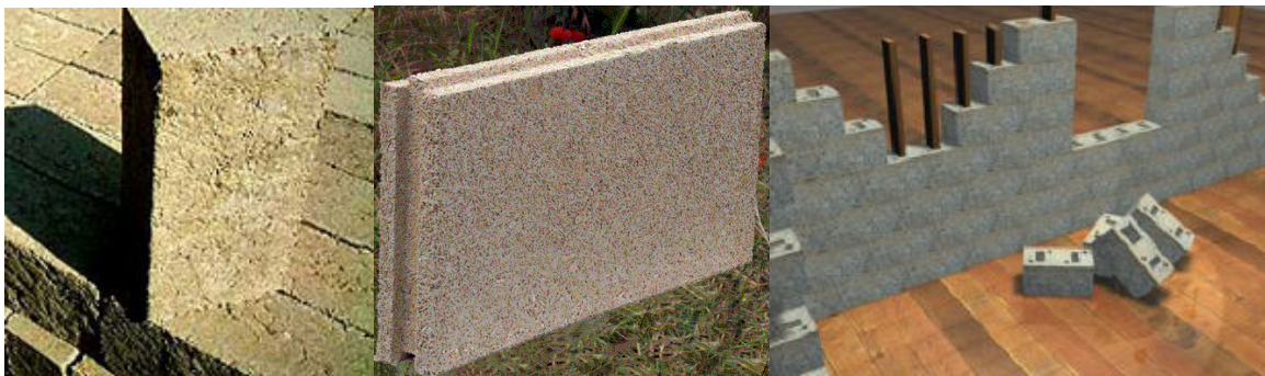
Bouwstenen uit kalk en hennep (links: Canabric, middens: Hestia, rechts: Easychanvre)
